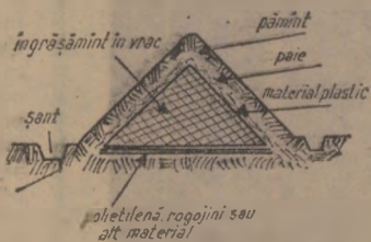
Depozitare provizorie, în vrac
