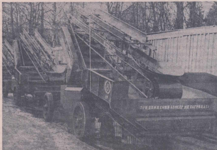
R.S.S. Estonă. La uzina constructoare de mașini agricole „Viit” din Tartu a început producția unui nou transportor-incărcător universal „T.Z.K.-30”, destinat mecanizării lucrărilor în marile depozite de cartofi. Productivitatea lui este de 30 tone pe oră. Noua mașină are brațul lung de 8 m și se poate deplasa singură pe lungimea cablului de alimentare — 50 m. În acest an uzina va produce sute de astfel de agregate. În fotografie: transportoare-incărcătoare „T.Z.K.-30” gata de expediție.
