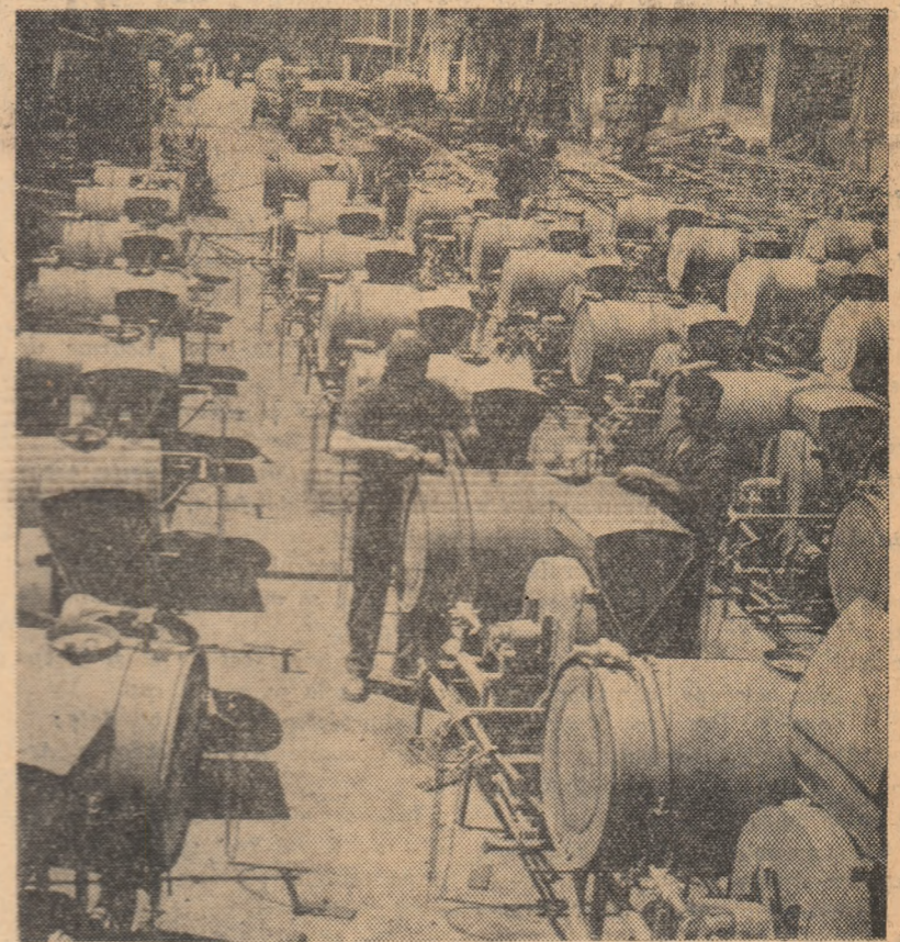
La întreprinderea metalurgică Dealul Spirii din București se lucrează la un nou lot de pompe și mașini de stropit și prășit necesare unităților agricole. În fotografie: muncitorii din echipa condusă de tov. Toma Georgescu execută montajul acestor mașini.
