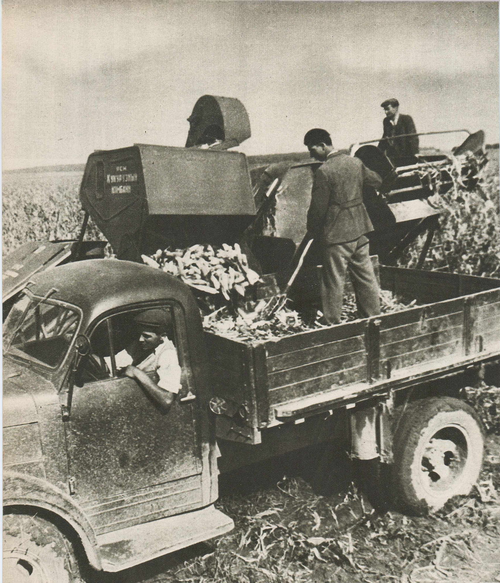
O combină sovietică „K.U.2” a intrat în porumbiștea g.a.s. din Secueni, raionul Roman. Știuleții sînt despărțiți de coceni, iar aceștia sînt tocați și transformați în furaje. Cu ajutorul acestei mașini, trei oameni realizează ceea ce manual ar necesita zeci de brațe de muncă. (Foto AGERPRES)
