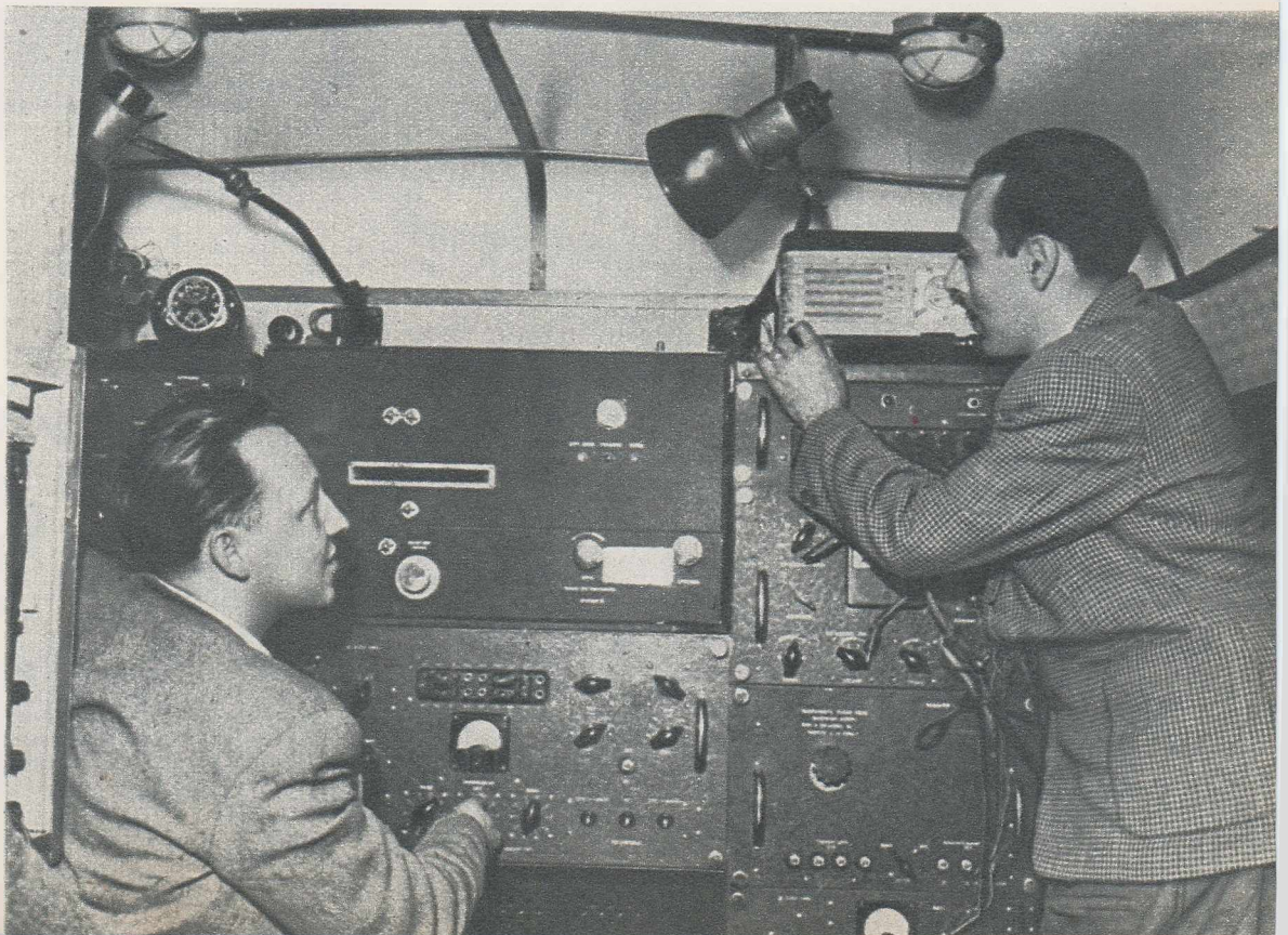
P. Romiță, Băicoi. Din stație se urmăresc operațiile de carotaj radioactiv ce se desfășoară la o sondă. →
