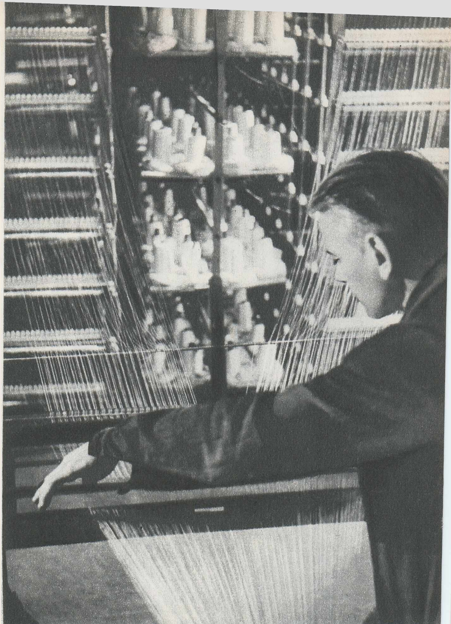
Această ramă a mașinii de urzit dă astăzi, grație inovației meșterului Petre Petrescu, o productivitate triplă.
