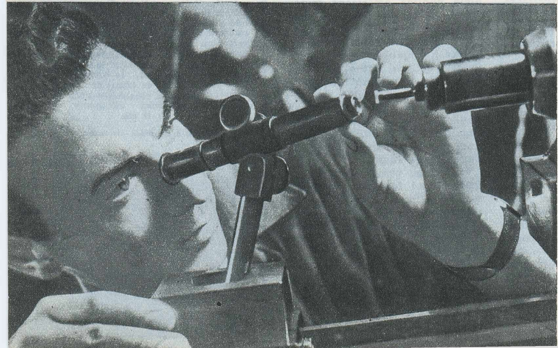
Printr-o lunetă specială se urmărește minuțios centrarea lentilelor mici.
