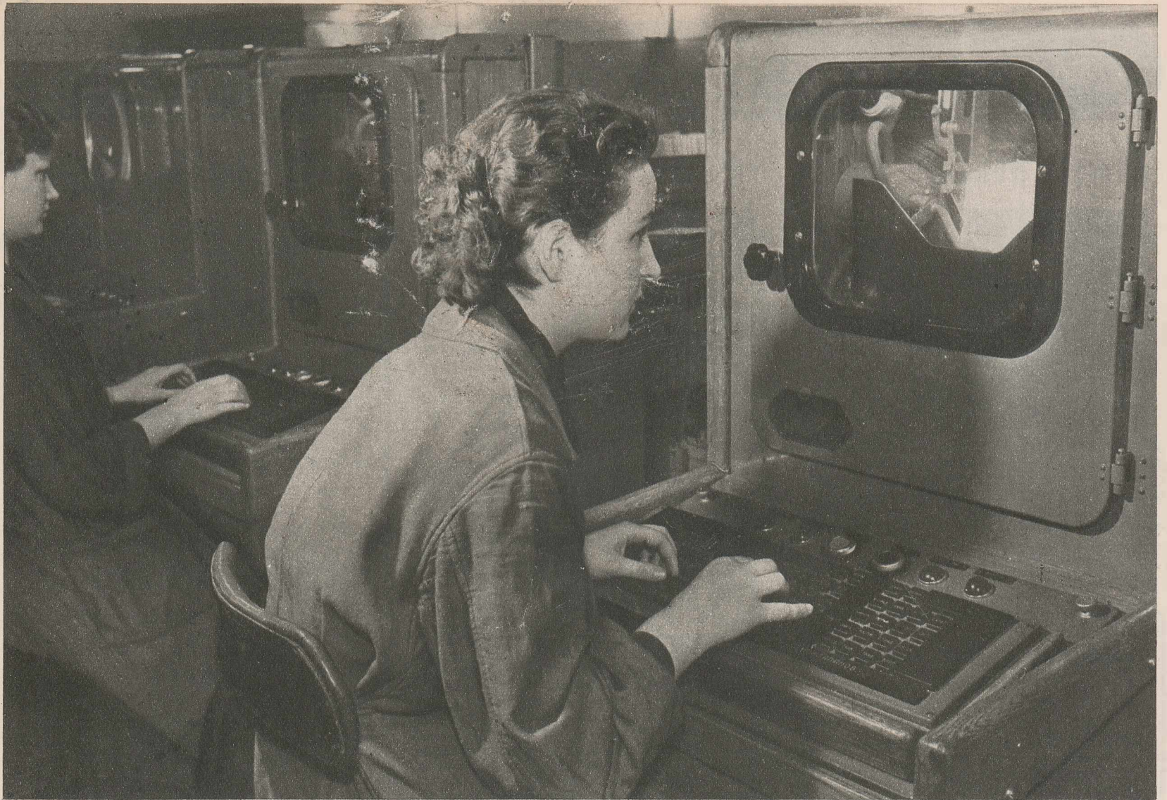
Unul dintre aparatele cele mai perfecționate pentru cartare. Aci, cartarea se face cu ajutorul televizunii. Când pe ecranul televizorului apare imaginea scrisorilor, lucrătoarea apasă pe un buton și scrisoarea e îndreptată spre sectorul respectiv.
