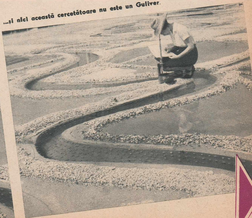
Flăcări? Jocuri de artificii? Nu, ceva mai prozaic, care în termeni științifici se numește „spectrul deformărilor unui masiv de pămînt sub acțiunea unei fundații rigide încărcate”, iar în vorbirea curentă, studiul deplasării particulelor de pămînt sub o fundație.
