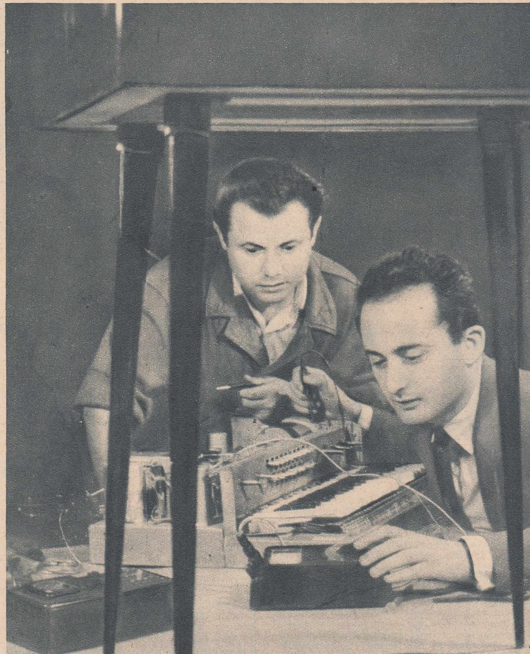
Se pregătește, la fabrica „Doina”, aducerea pe lume a primului instrument muzical electronic produs la noi în țară (de către Ing. Ion Moceanu și constructorul Ioan Băisan) numit electrofon marca „Sideral”. Sunetele instrumentului sînt create cu ajutorul unui oscilator cu tuburi electronice, comandat de o serie de contacte acționate de o claviatură de acordeon.
