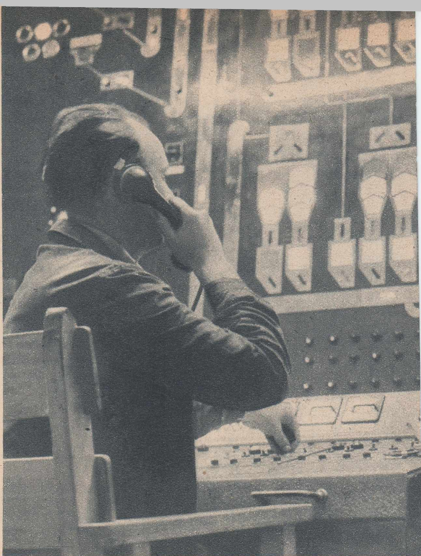
De aici, de la pupitrul de comandă, dispecerul urmărește și conduce întreg procesul tehnologic de preparare a amestecului din care se va naște sticla...
