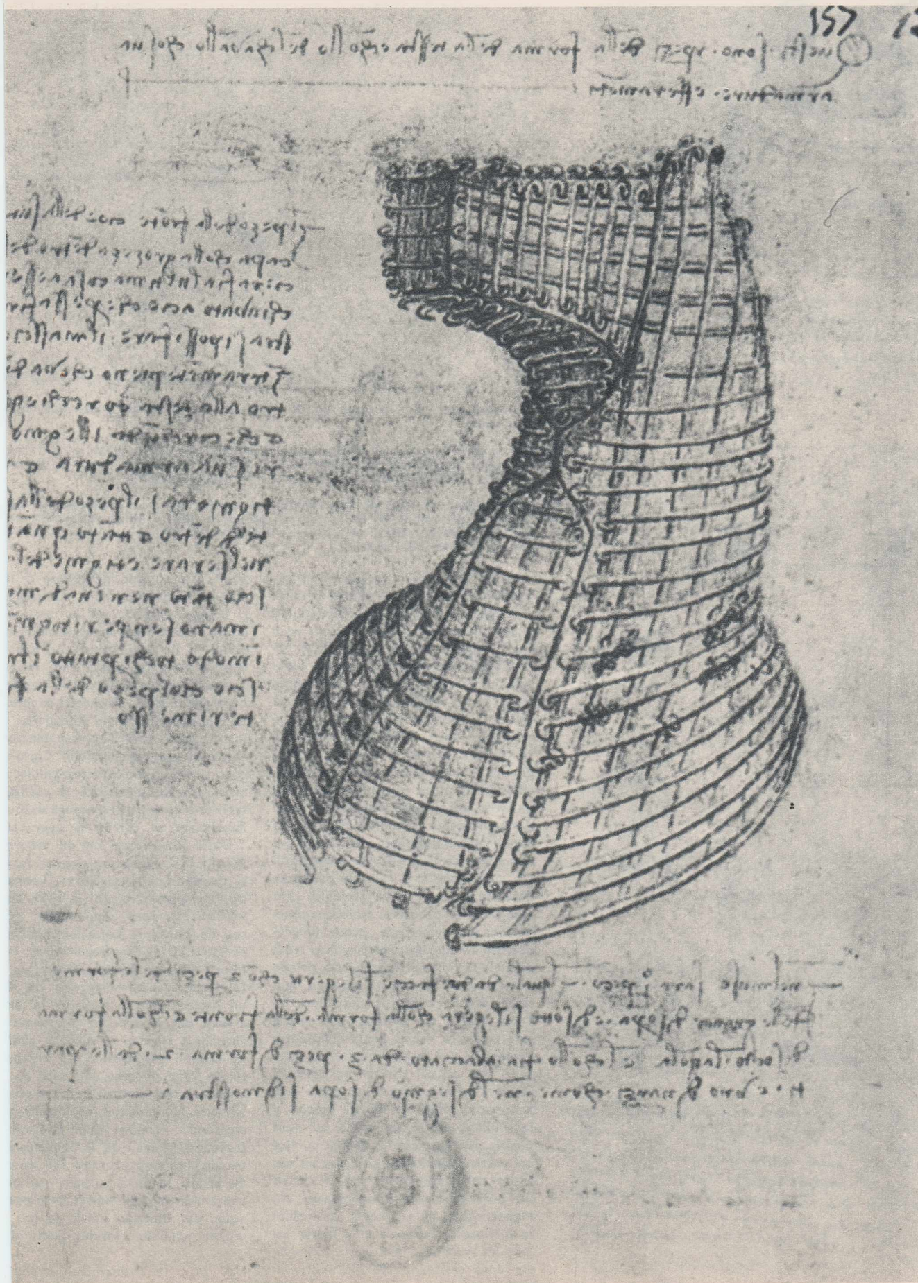
Desenul, în detaliu, al scheletului lemnos al mulajului care reprezintă capul și gîtul uriașului cal.
