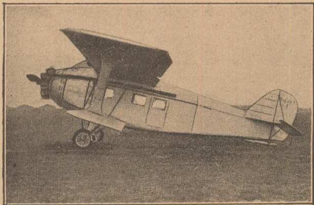
Avion francez de pasageri „Breguet“ tip. 26 T. Motor Gnome e Rhone Jupiter 420 H. P. Construit în dur aluminiu.
