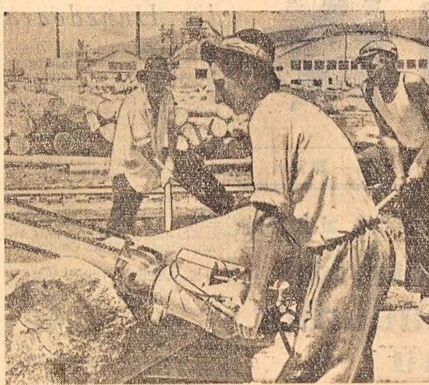
„Multe din unitățile de industrializare a lemnului printre care și cea din comuna Zăvoi, regiunea Timișoara, lucrează mecanizat. În cliseu: Echipa de lucrări complexe condusă de tov. Moderator Carol folosește ferăstrăul electric la tălătul busturilor”
