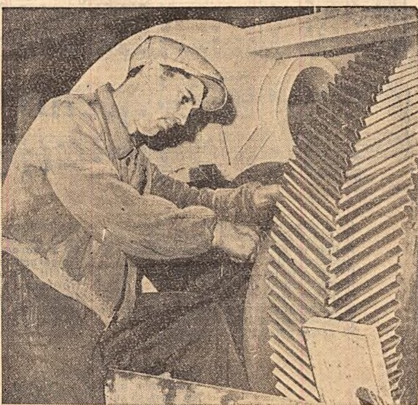
Lăcătușul montator Manolache Mihalache de la atelierul de montaj greu al uzinelor „Mao Tze-dun” din Capitală, montînd piesele unei pompe triplex. (Foto M. Cloc)
