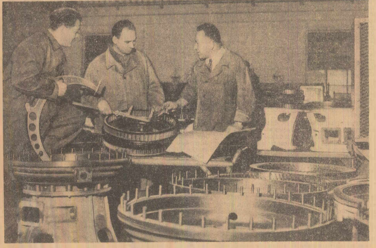
Uzinele „Hidromecanica” din Brașov. Schimb de păreri, în legătură cu tehnologia de fabricație a convertizorului pentru instalații de foraj
