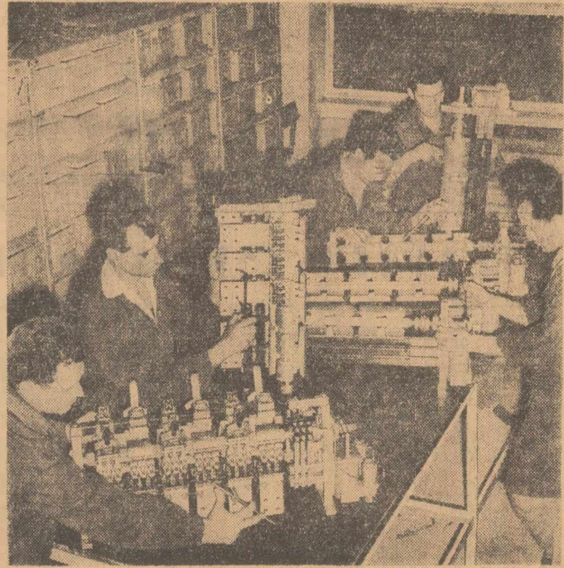
Secția aparataj pentru locomotive Diesel-electrice de la uzina „Electroaparataj”-București. Echipa condusă de Marin Fundăneanu efectuează un ultim control la un lot de inversoare. Foto : R. Costin
