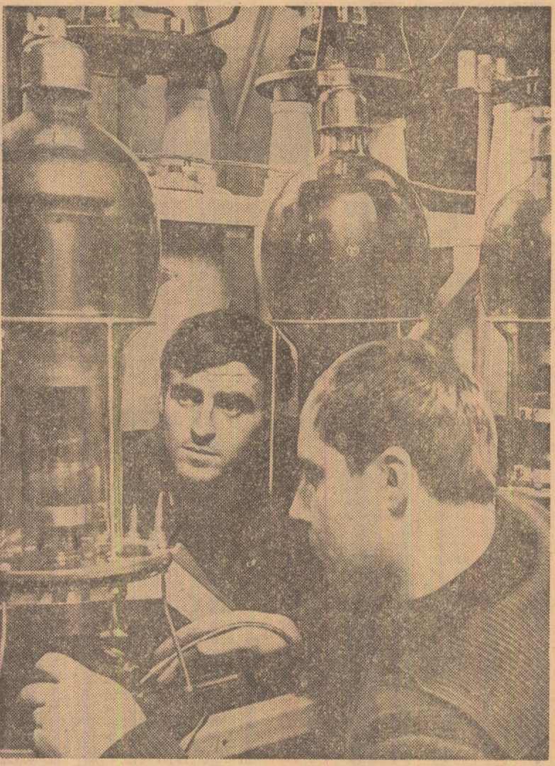
La Uzina metalurgică Iași sint în curs de aplicare măsuri pentru perfecționarea tehnologiilor de fabricație. Fotografia redă o imagine a cercetărilor ce se întreprind pentru trecerea de la sudura normală a unor tipuri de țevi la sudura prin curenti de înaltă frecvență
