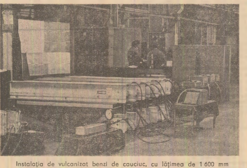
Instalația de vulcanizat benzi de cauciuc, cu lățimea de 1.600 mm
