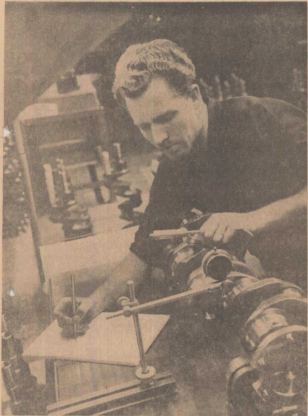
Si acest arbore motor, pe care îl controlează Constantin Balat, intrunește toate calitățile cerute de documentația tehnică. El poate porni mai departe pe fluxul tehnologic al Uzinei de tractoare din Brașov
