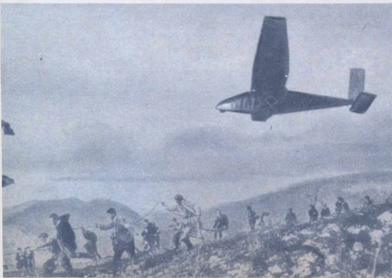
Planorul Vampyr, lansat în zbor cu ajutorul sandoului.
