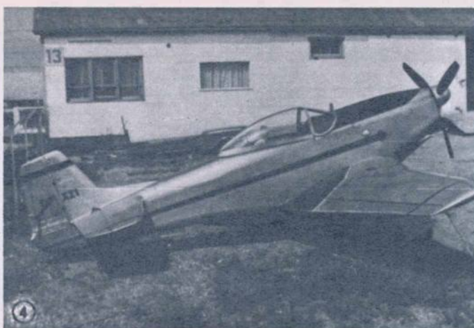
4. MJ-7 H «Gnatsum» cu motor de 220 CP, construit în Canada.
