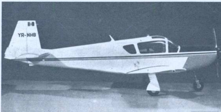
IAR-823: caracteristici: anvergură — 10 m; lungime — 8,240 m. Performanțe (versiunea cu 4 locuri): viteză maximă — 270 km/oră; viteză de croazieră — 252 km/oră; viteză maximă în picaj — 370 km/oră; lungimea de rulare la decolare — 230 m; raza de acțiune — 700-1350 km
