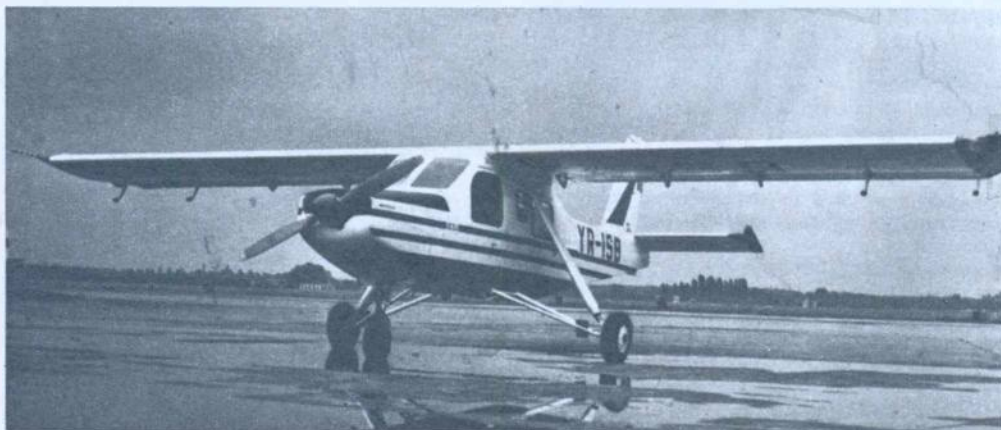
IAR-824: caracteristici: anvergură—12,4 m; suprafața portantă — 23,3 mp; lungimea — 9,2 m; greutate gol — 1 240 kg; greutate totală — 1900 kg; încărcare — 81,5 kg/mp. Performanțe: viteză maximă — 220 km/oră; viteză de croazieră — 200 km/oră; viteză minimă — 82 km/oră; timp de urcare la 1000 m — 5 min; distanță de decolare — 240 m; distanța de aterizare — 140 m; distanța de zbor — 700 km.
