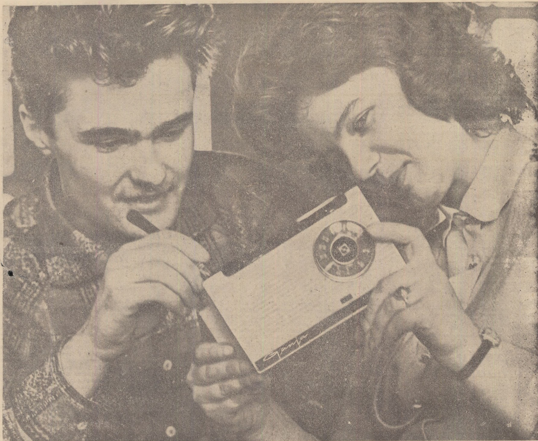
Noul aparat de radio cu tranzistori „Gauia” fabricat la Riga. Are gamă de unde medii și lungi, prinde ziua 8—10 posturi, iar seara peste 30, cântărește 600 gr.
