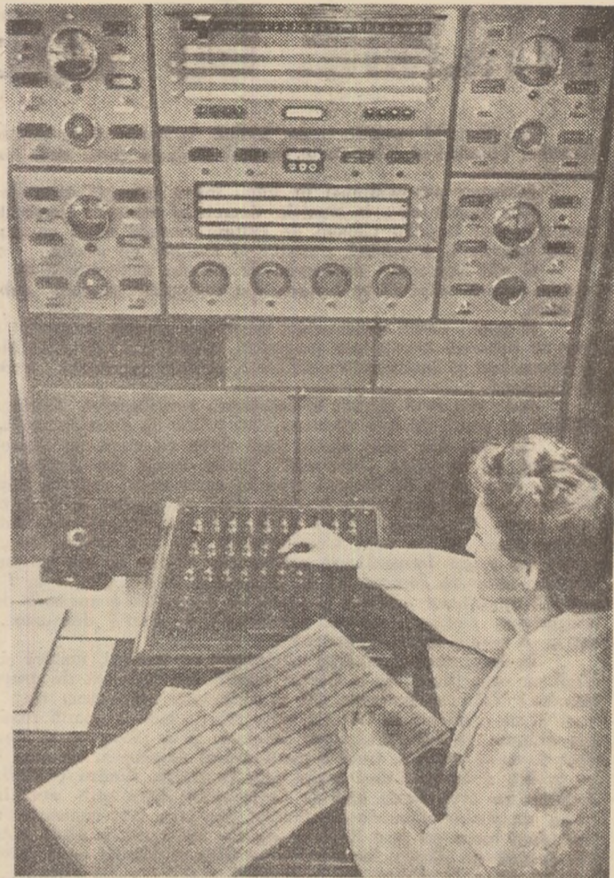
Automatizare... De la pupitrul de comandă al benzilor transportoare dispececul urmărește atent montarea aparatelor de fotografiat „Smena”.
