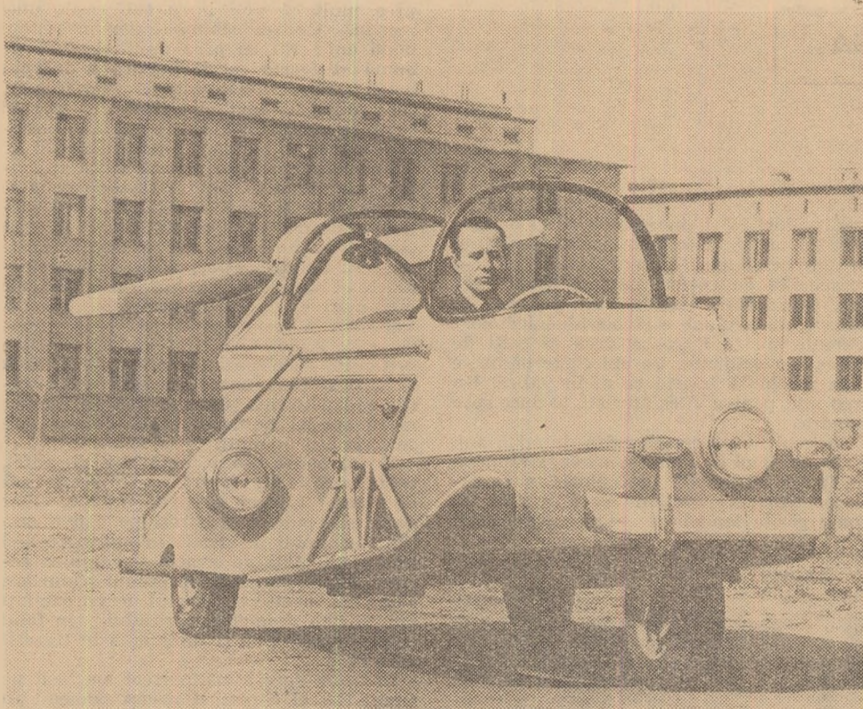
„Autoaeromobilul” din fotografie a fost construit de mecanicul bielorus V. Kurunkov. Mașina dezvoltă o viteză de 120 km/h pe uscat, 80 km/h pe zăpadă și 50 km/h pe apă
