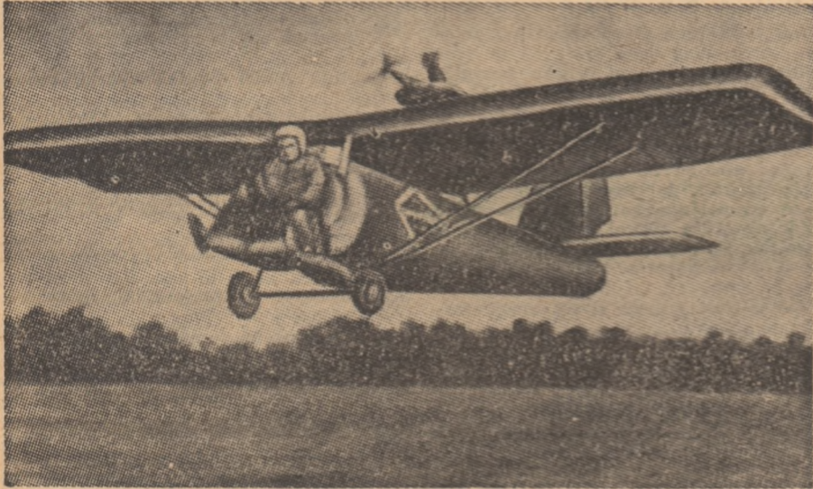
Cu excepția motorului și elicei, acest avion este construit în întregime dintr-o membrană umplută cu aer sub presiune. Dacă se scoate din el aerul, poate fi transportat într-un geamantan.
