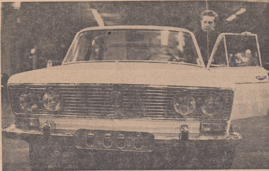
Incepînd de luna trecută, Uzina de automobile din Togliatti produce un nou model de autoturism, „VAZ-2103”. Acesta consumă 9—10 litri la suta de kilometri, poate dezvolta o viteză maximă de 150 km pe oră, iar motorul are o putere de 75 CP. În fotografie: „VAZ-2103”.
